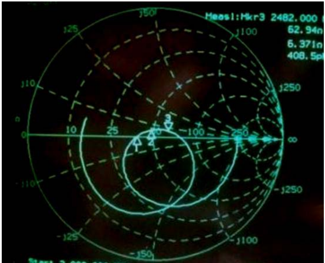
图 35.使用实际组件的 Smith 图表
