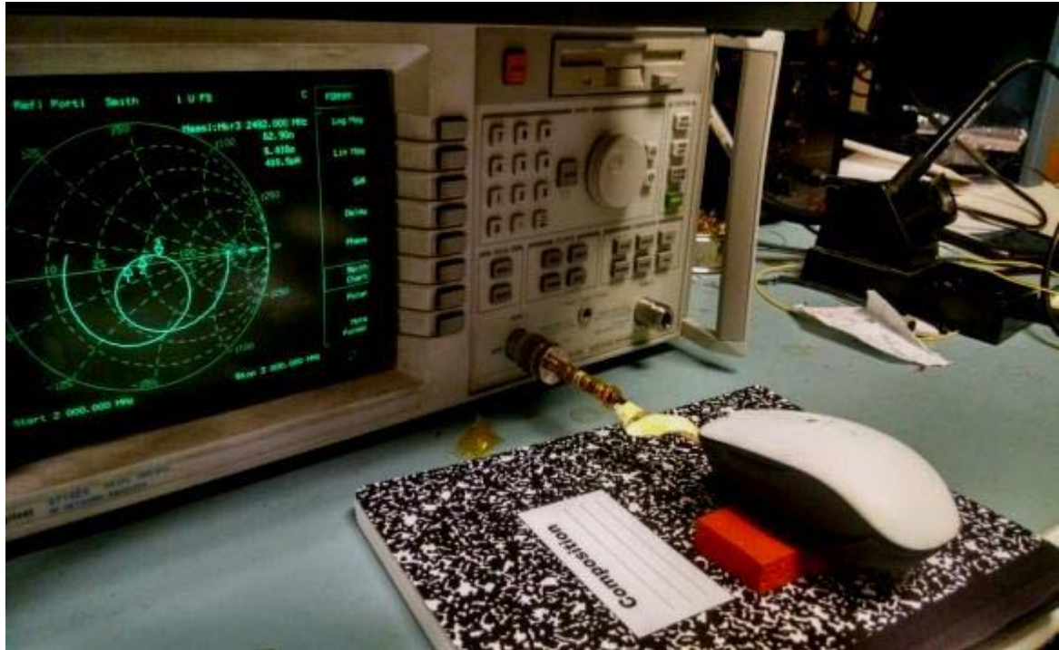
图 37.使用塑料装置时的 SmithChart，连接至 ID 的图表
